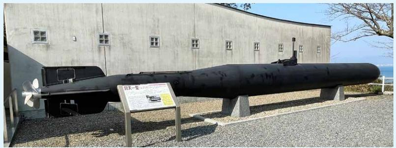
回天一型 実寸大のレプリカ(全長14.75m、胴体の直径は1m)
